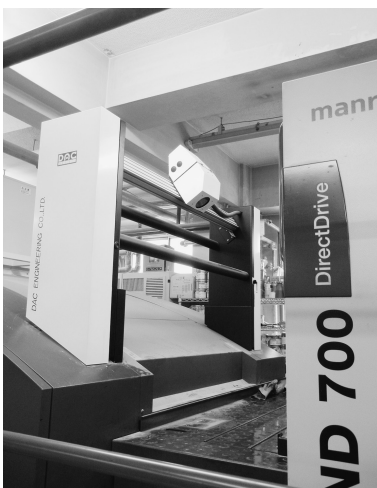
ダックエンジニアリングの検査装置を全印刷機に設置
